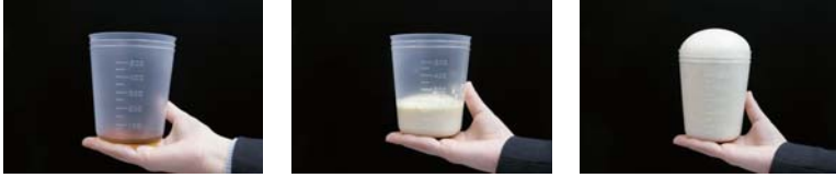
① A液とB液を混合する。 ② 化学反応により発泡する。 ③ ウレタン樹脂が形成される。
