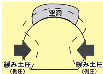
農業用水路トンネルでは、側壁におけるクラックの発生、底盤の摩耗など、補修や補強が必要と考えられる変状が多く発生しています。
