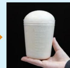
硬質発泡ウレタンはA液(ポリオール)B液(イソシアネート)の2液が、短時間で液体→固体へと化学反応により状態を変えながら形成される樹脂です。地盤に注入された2液は、この化学反応を起こしながら、半径1~1.5m程度の影響範囲で広がります。
